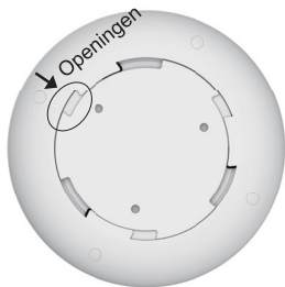
Niet goed bevestigd
